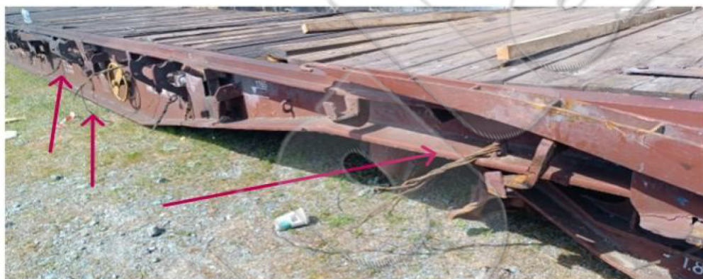
Φώτο 42. Διάτμηση των συρμάτινων δεσιμάτων των λαμαρινών
