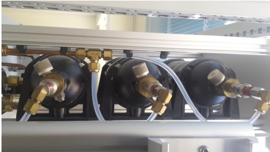
Σχήμα 3.2: Φιάλες άμεσης παροχής υδρογόνου
