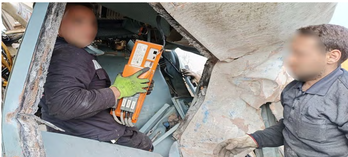
Φώτο 3. Ανάκτηση του καταγραφικού Hasler-TELOC 2510 από ηλεκτράμαξα 120-022
