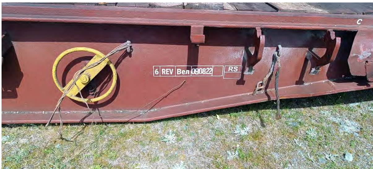
Φώτο 42α. Διάτμηση των συρμάτινων δεσιμάτων των λαμαρινών
