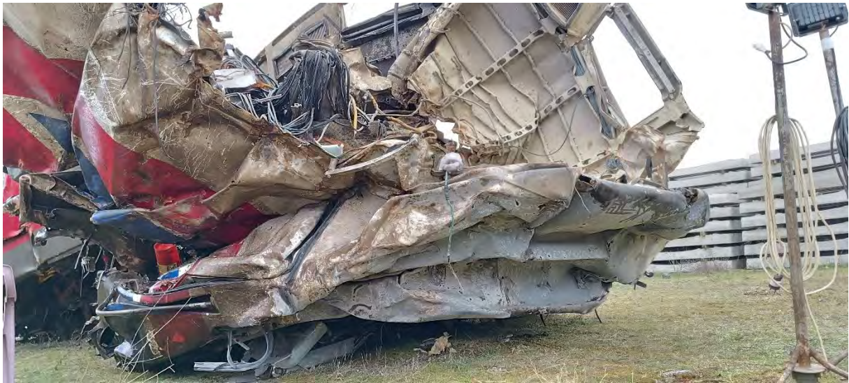
Φώτο 26. Ηλεκτράμαξα 120-022, αναδίπλωση θαλάμου διακυβέρνησης εμπρόσθιας πλευράς
