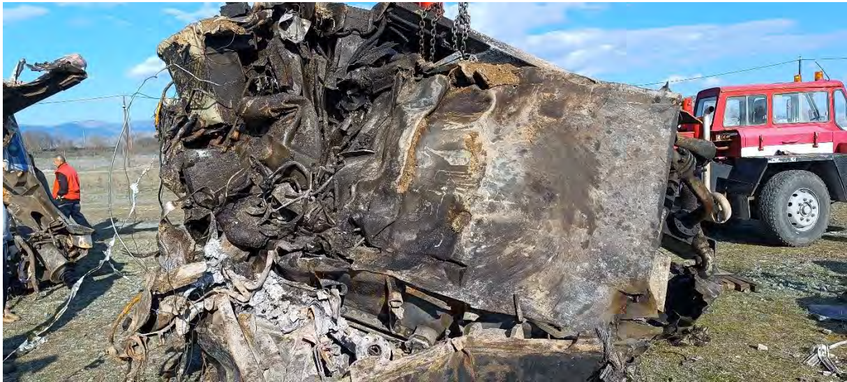
Φώτο 35α. Μετασχηματιστής ηλεκτράμαξας 120-023, (επιβατική IC62)
