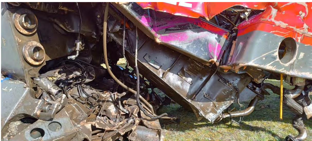
Φώτο 22α. Μετασχηματιστής ηλεκτράμαξας 120-022, αριστερή πλευρά κατά την φορά κίνησης
