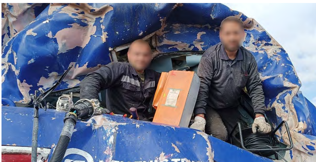
Φώτο 1. Ανάκτηση του καταγραφικού Hasler-TELOC 2510 από ηλεκτράμαξα 120-012
