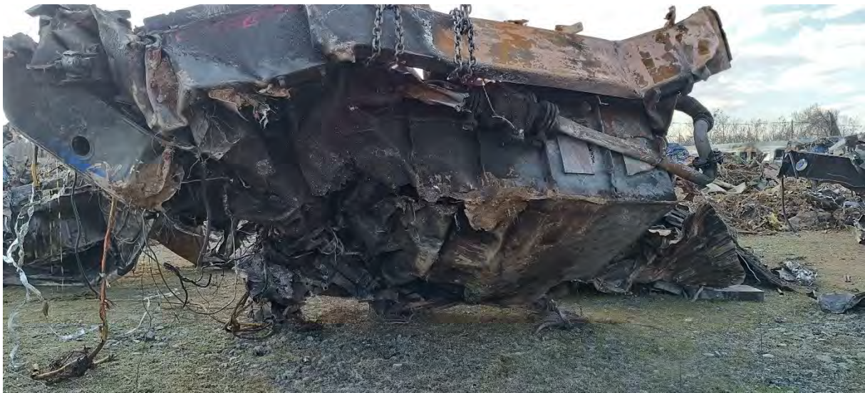
Φώτο 35. Μετασχηματιστής ηλεκτράμαξας 120-023, (επιβατική IC62)
