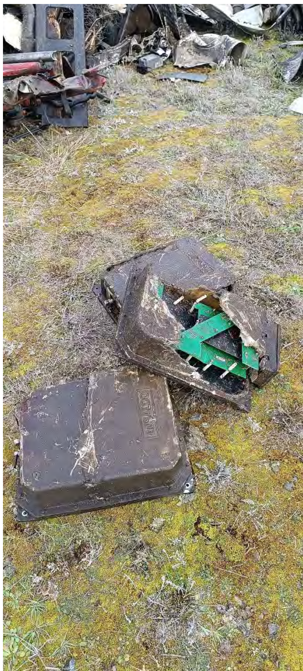
Φώτο 6. Κεραίες AnsaldoSTS πιθανόν από ηλεκτράμαξες 120-012 και 120-022
