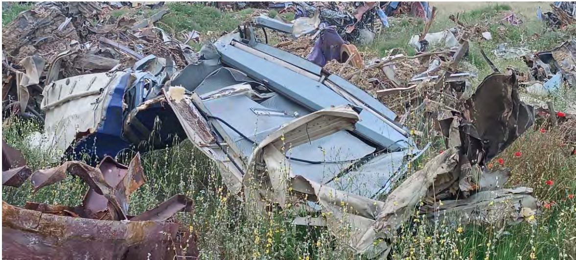
Φώτο 30. Τμήμα θαλάμου της ηλεκτ/μαξας 120-012 της πίσω πλευράς (κατά την φορά κίνησης)
