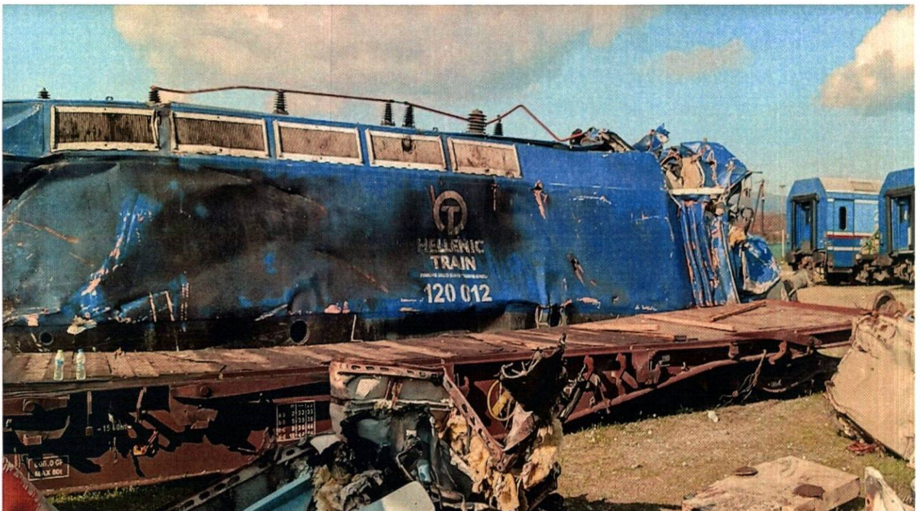
Εικόνα 23 Η υπ. αριθμ 120-012 ηλεκτράμαξα της εμπορικής αμαξοστοιχίας. Διακρίνονται τα καμένα έλαια ψύξεως του ΜΣ.
