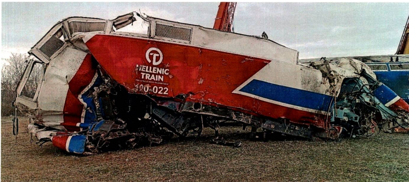
Εικόνα 20 Η 120-022 ηλεκτράμαξα της επιβατικής αμαξοστοιχίας με διαρρηγμένο ΜΣ.
