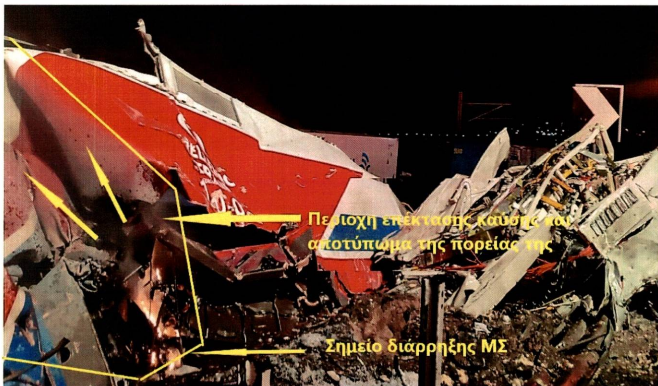
Εικόνα 21 Ο ΜΣ της 120-022 ηλεκτράμαξας της επιβατικής αμαξοστοιχίας πριν την απομάκρυνση του από τον τόπο του ατυχήματος.
